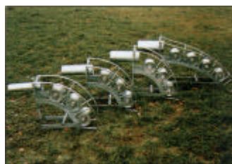
Kaapelin ja köyden sisäänvienti- laitteet, sinkitty
